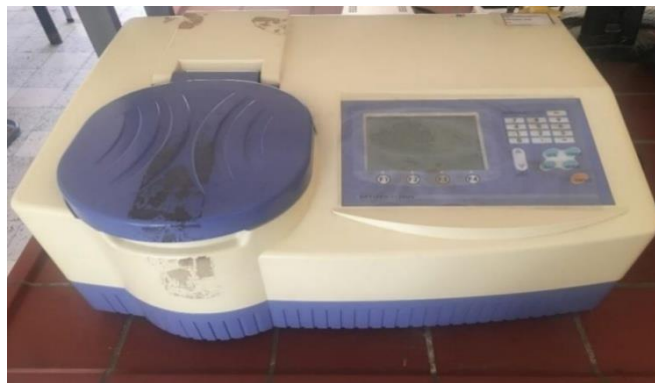
Figure II.4 : Photographie du spectrophotomètre UV-Visible (OPTIZEN 2120 UV)
