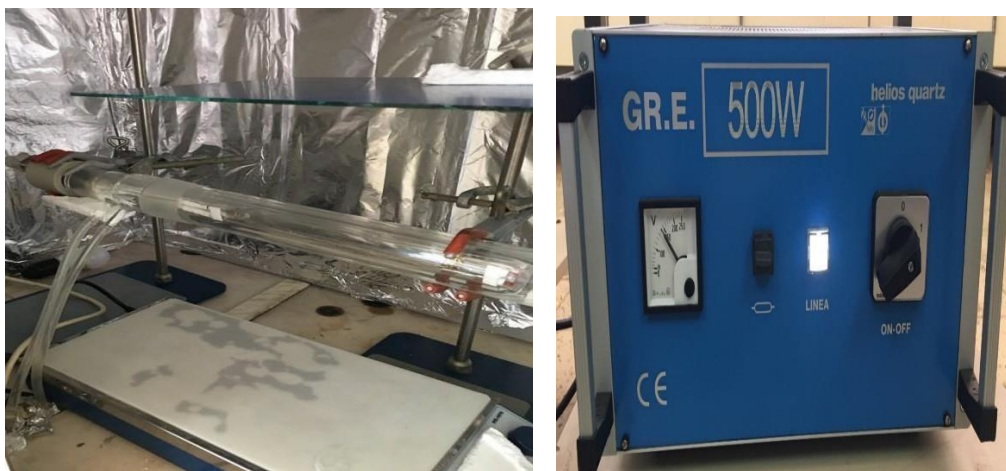
Figure I. 3 : Le réacteur photocatalytique doté de sa lampe UV
