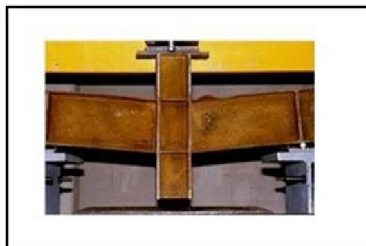
Figure II.8 : Voilement local de la membrure de l'âme supérieure [8]
