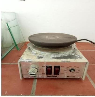
**Figure 16 :** Agitateur magnétique.
