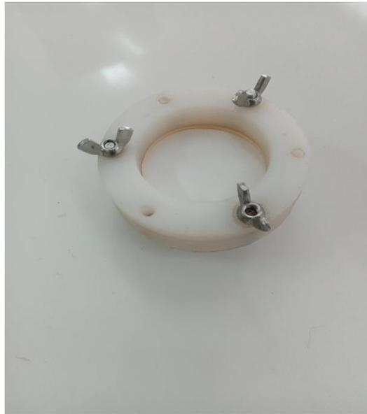
**Figure 19 :** Tasse d'eau de mesure de perméabilité de vapeur d'eau.
