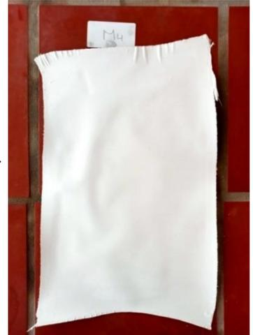
Membrane en PVC avant de plonger dans l'eau
