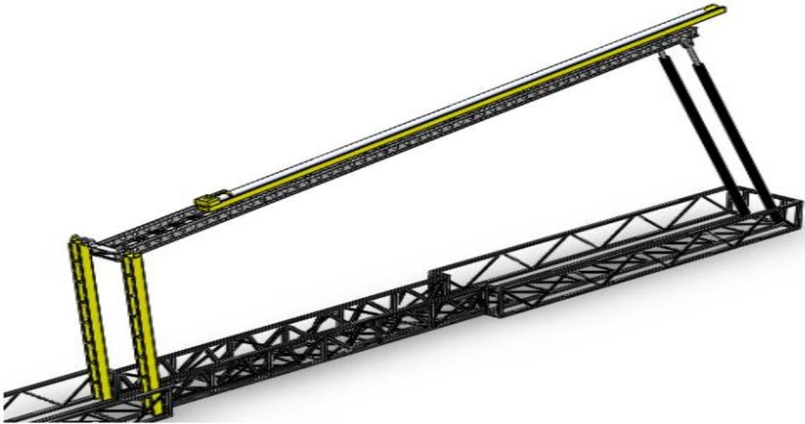
Figure II.16. Mécanisme à cinq barres avec joint en P pour passerelle automatique.
