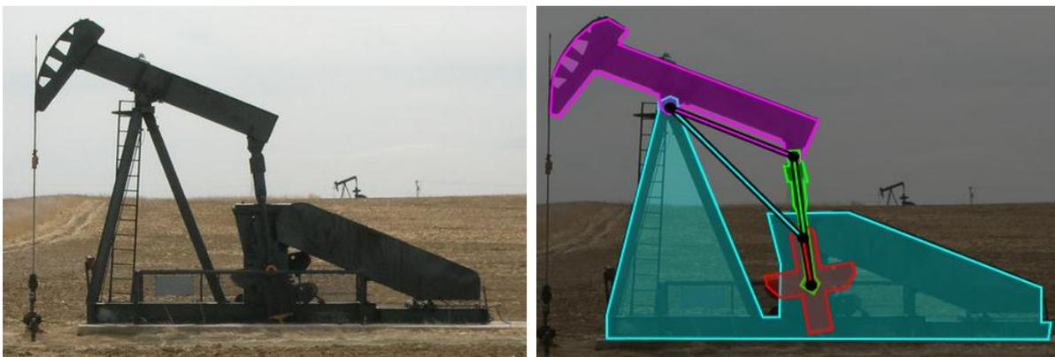
**Figure II.9. Cric de pompe (mouvement rotatif à réciproque).**
