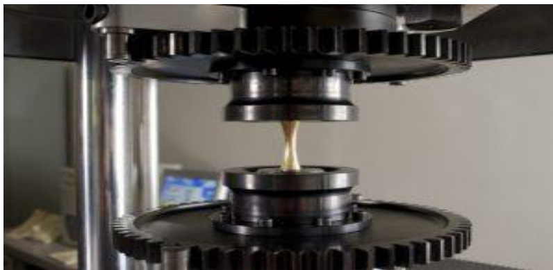
Figure 4:Essais de fatigue
