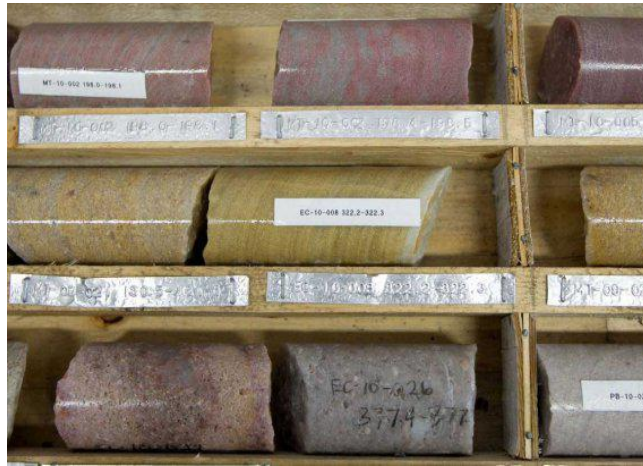
Figure n°39 : Exemple d'un essai de carottage.
