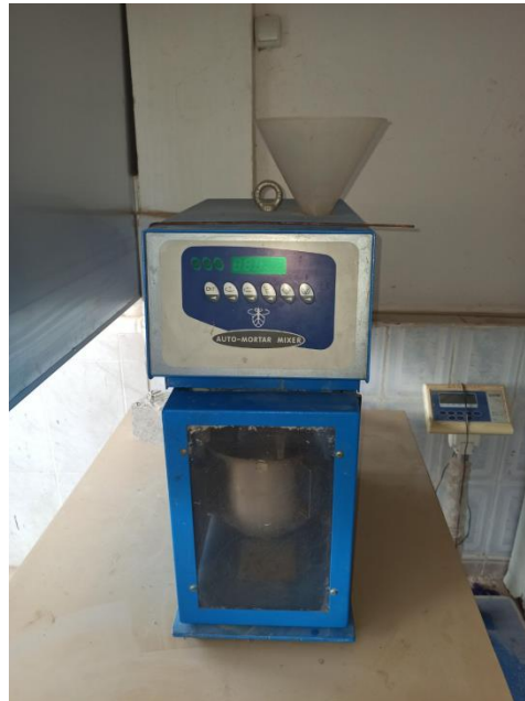
Figure II - 13 : Malaxeur électrique utilisée dans la fabrication du mortier [Labo de FST génie civil Mostaganem].
