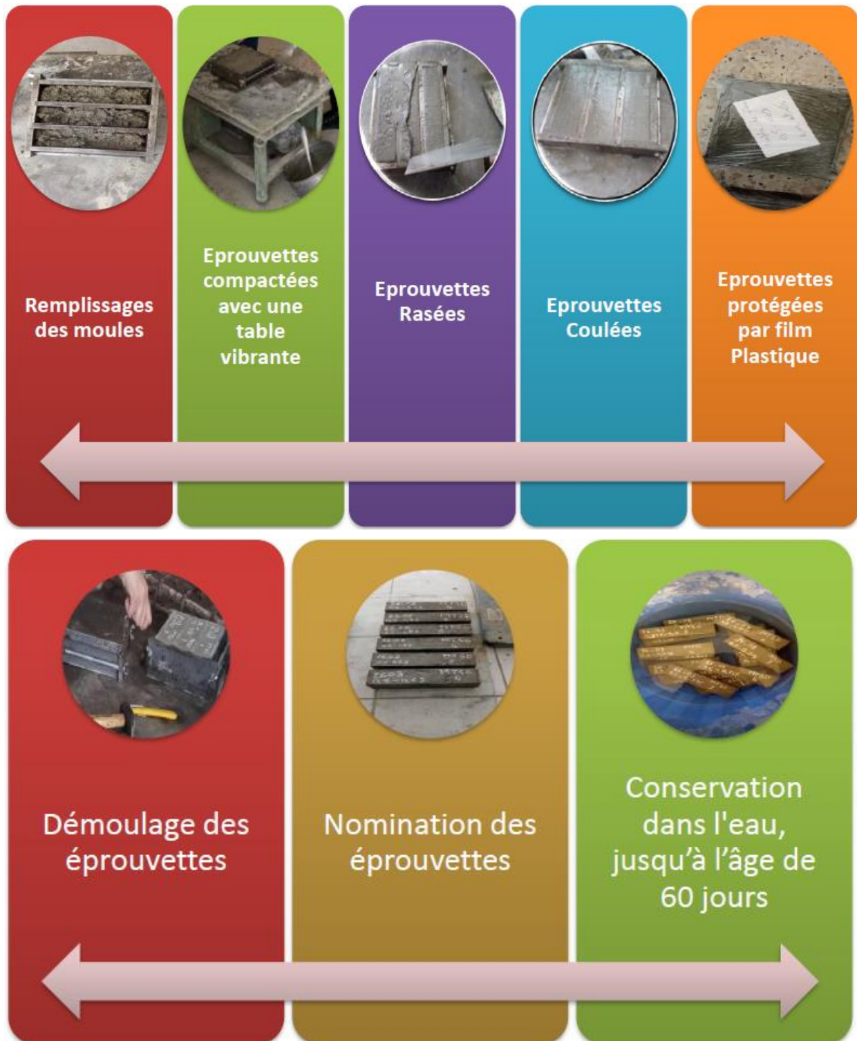
Figure II - 15 : Remplissage et Conservation des éprouvettes du mortier normalisé [Photos prises au laboratoire de recherche de FST Génie Civil Mostaganem].
