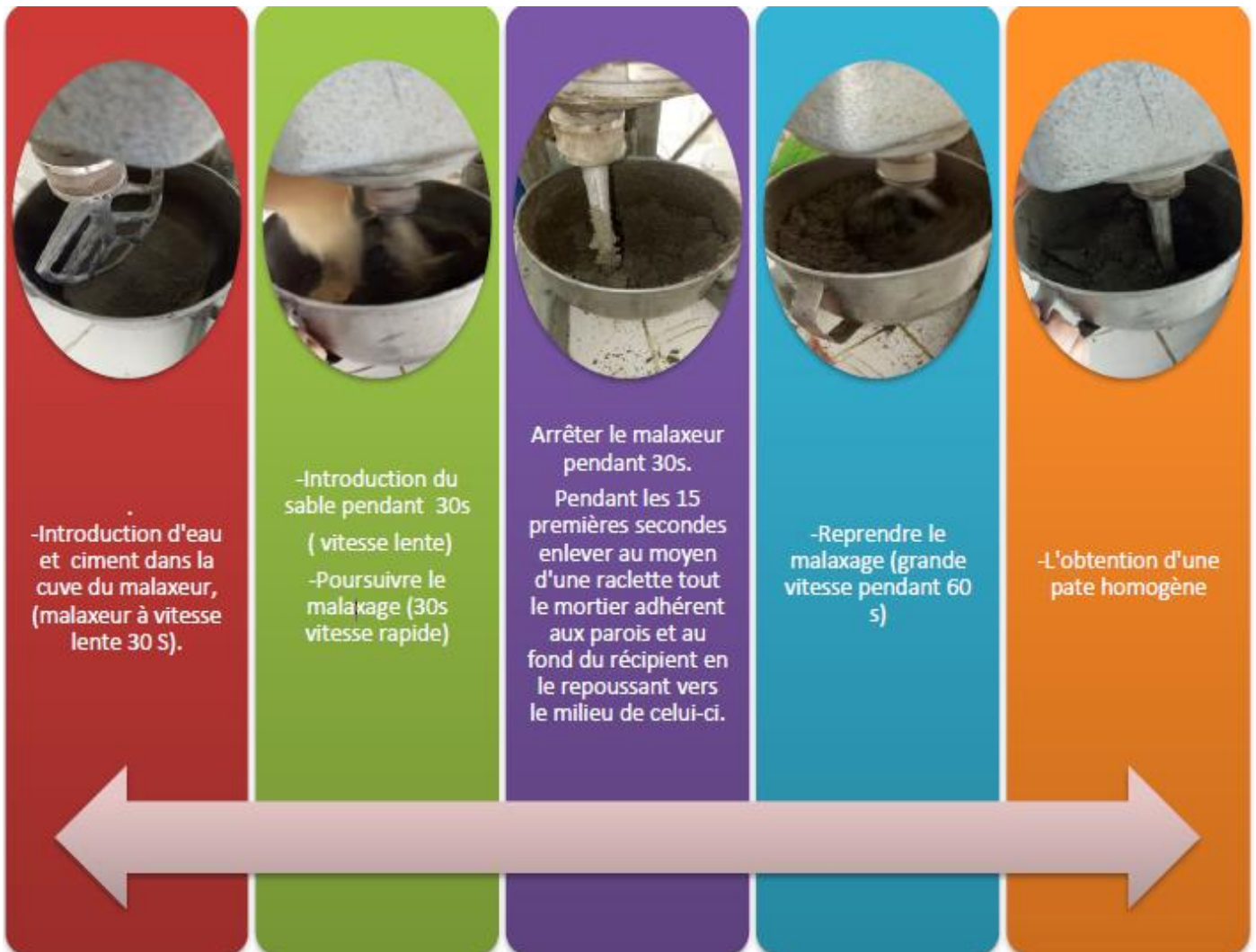
Figure II - 14 : Les étapes de malaxage du Mortier normalisé.
