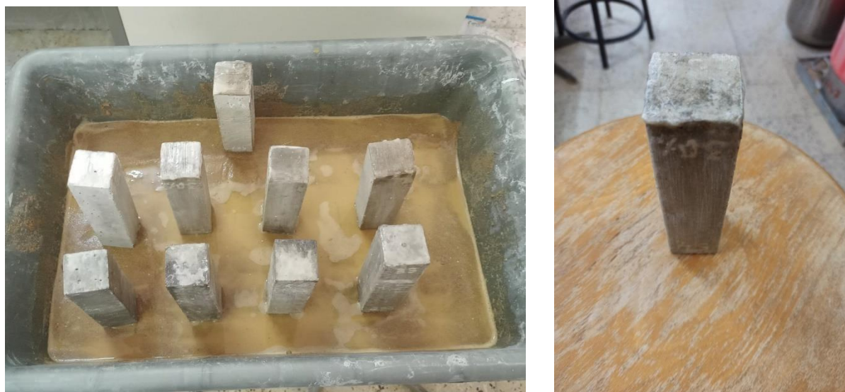
Figure II - 16 : Montage expérimental pour l'essai d'absorption capillaire.
