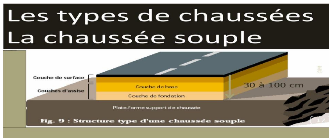
Figure 05 : Structure type d'une chaussée souple.
