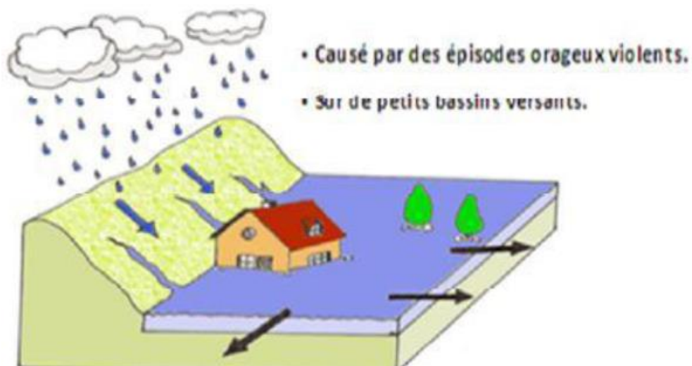
Figure II. 6 : Inondation par ruissellement en secteur urbain (Merabet, 2006)
