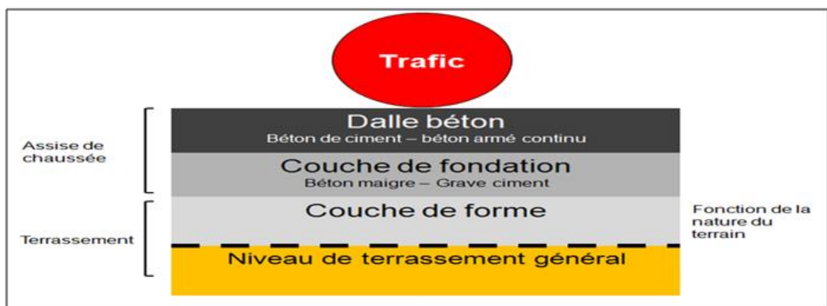
Figure VII.3 : Structure type d'une chaussée rigide.
