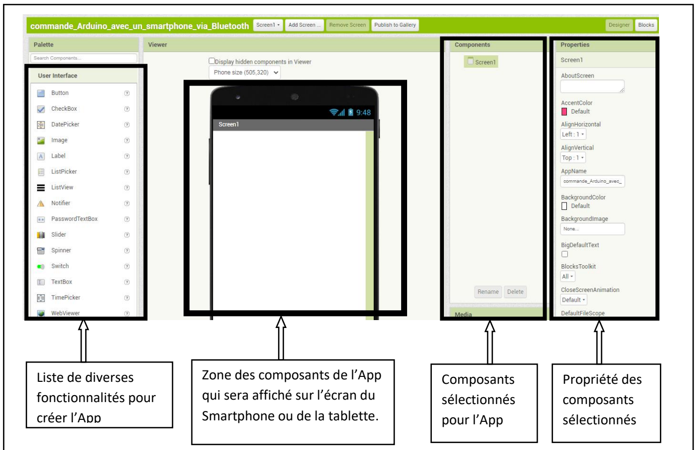
Figure III.5 Interface de création de l'application MIT Inventor
