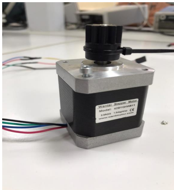
Figure 8 : Moteur pas à pas 42BYGHW811
