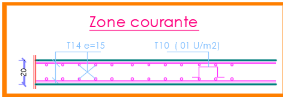
Figure 3.6 : le ferrailage de la dalle
