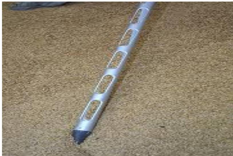
**Figure N°17 :** Une sonde d'échantillonnage
