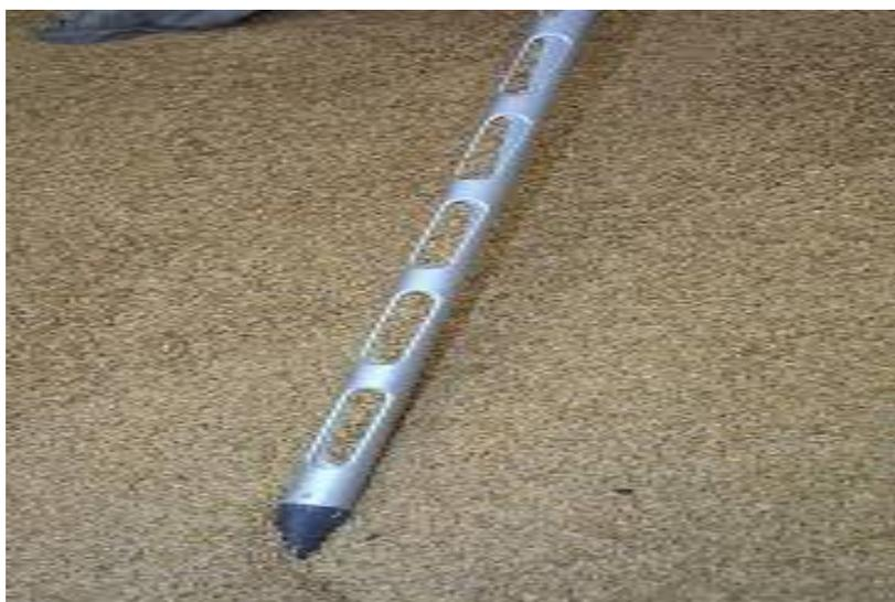
**Figure 17** : Une sonde d'échantillonnage.
