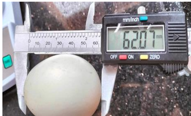
Figure 6: Mesure de dimensions des œufs à l'aide du pied à coulisse
