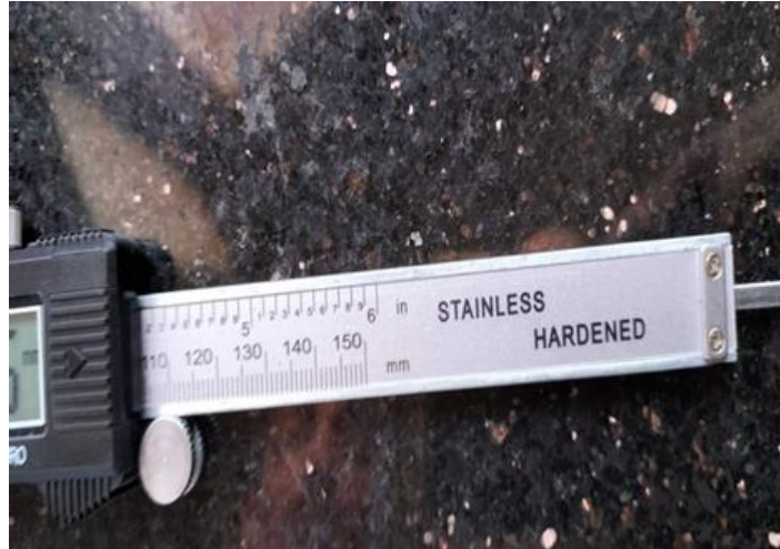
Figure 3: Un pied à coulisse digital( \pm 0.01\text{mm} )
