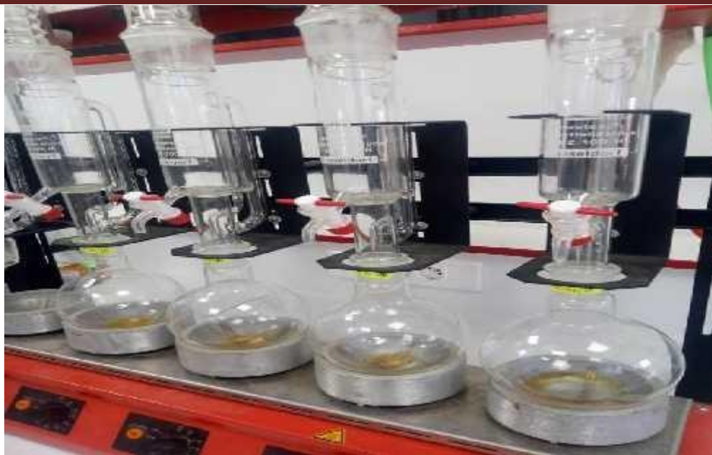
Photo 04 : l'appareille d'extraction soxhlet.
