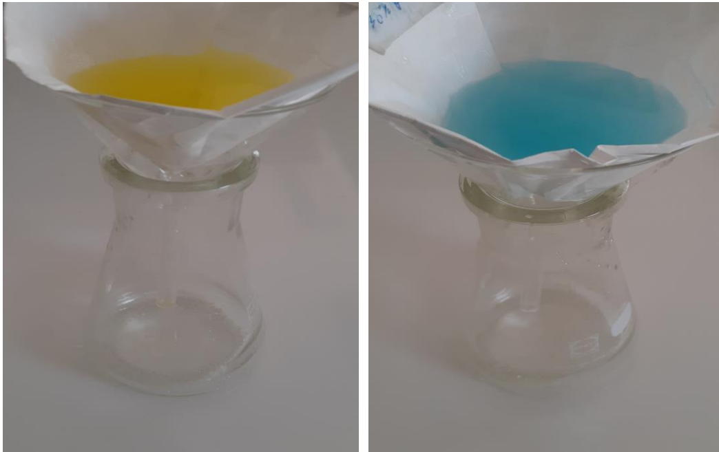
Figure 52: Séparation par gravité avec membrane M1
