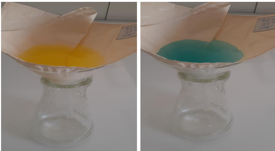
Figure 53 : Séparation par gravité avec membrane M3
