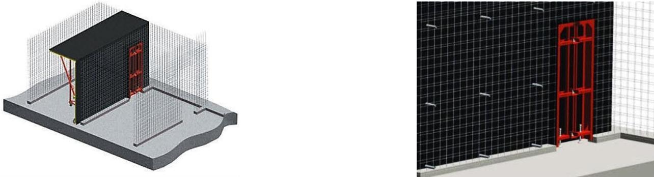
**Fig 08** : la mise en place des demi-coquilles
