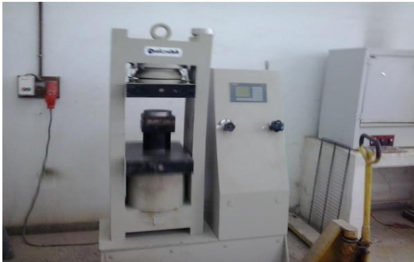
Figure 25 : Ecrasement d'éprouvettes.
