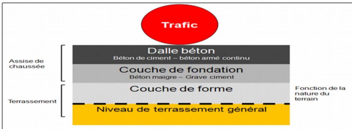
Figure VII.3 : Structure type d'une chaussée rigide.
