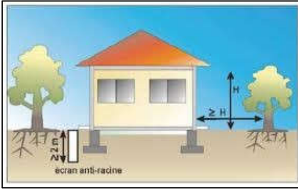
Figure I-17 : L'effet de l'affaissement de sol : Plantation d'arbre. [15]
