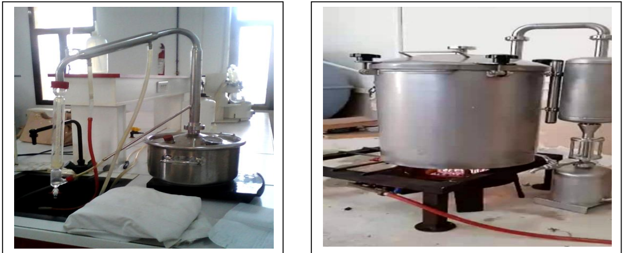
Figure n°11: Extraction de l'huile essentielle de lavande (feuille et fleurs) par hydrodistillation à vapeur
