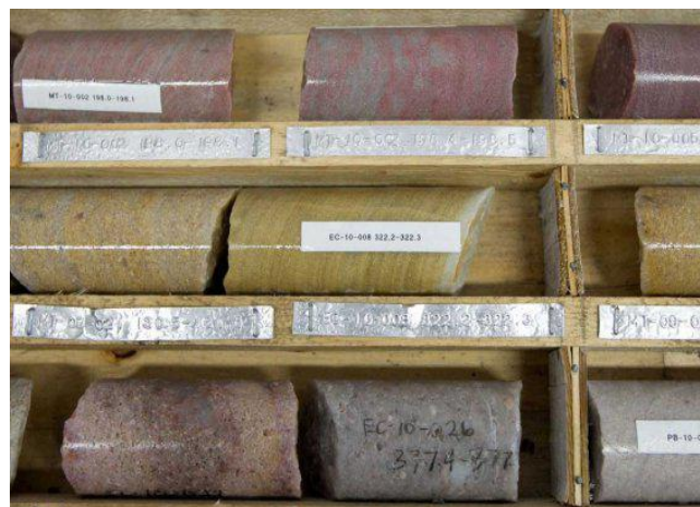
Figure n°39 : Exemple d'un essai de carottage.
