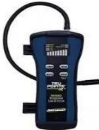
Fig.I.11. Détecteur de fluides frigorigènes Tru Pointe IR [17]
