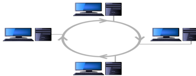
Figure I.12 : topologie en anneau
