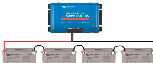
Figure V.10 : Branchement de régulateur avec les batteries. [35]
