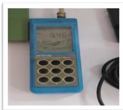
Figure n°15 : l'Oxymètre (Photo Iman Khadidja 2022)
