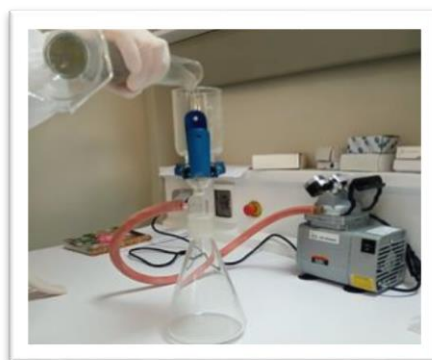
Figure n°16 : la filtration (Photo iman Khadidja 2022)
