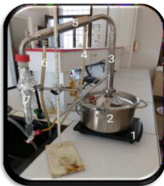
Figure 22 : Montage d'entraînement à la vapeur d'eau. 1: plaque chauffante, 2: cocotte-minute 3: condensateur, 4: sortie de l'eau, 5: réfrigérant, 6: entrée de l'eau et 7: tube gradué (Originale, 2022)
