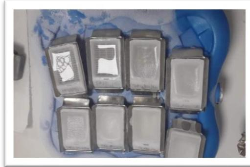
**Figure 16:** Inclusion des pièces avec de la paraffine.
