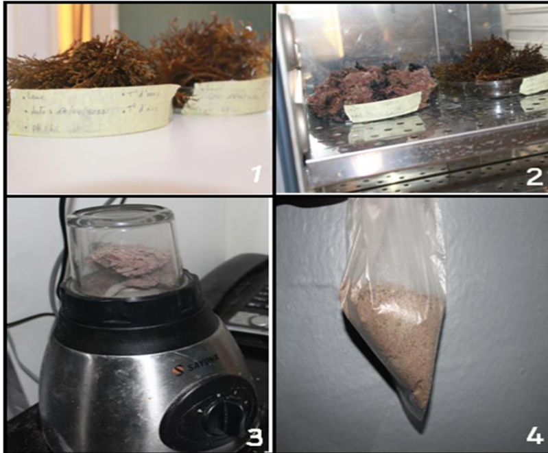
Figure 22. Etapes de la préparation de la poudre algale: 1. Nettoyage des algues avec de l'eau distillée, 2. Séchage des algues à l'étuve, 3. Broyage des algues dans un mixeur, 4. Poudre algale est prête à l'utilisation
