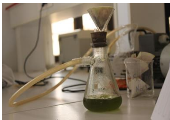
Figure 24. Filtration du mélange (poudre + méthanol)
