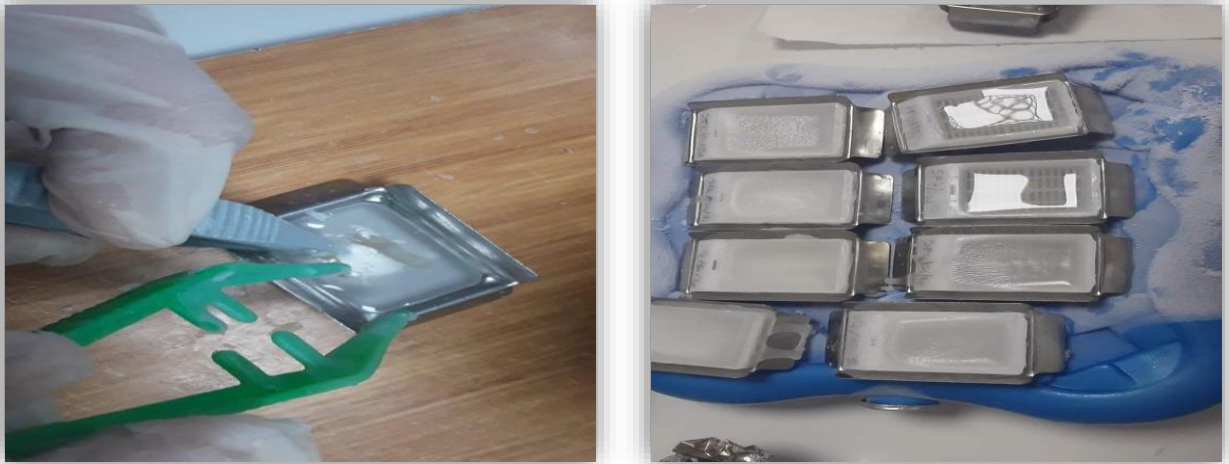
Figure 13 : l'enrobage des moules par la paraffine
