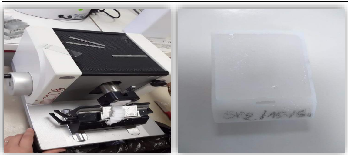
Figure14 : Microtomie et préparation de coupes en paraffine
