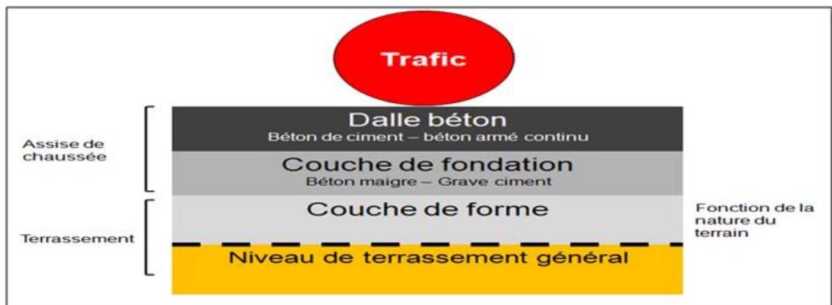
Figure V.3 : Structure type d'une chaussée rigide.
