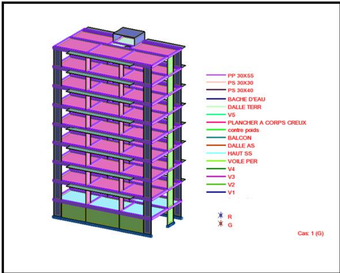
Figure IV.3.1: vue de structure en 3D
