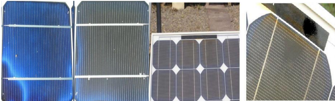
La détérioration de la peinture antireflet
