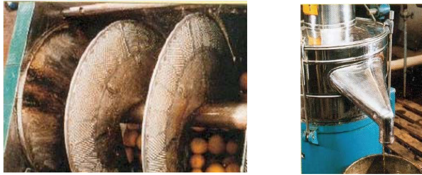
Figure n° 03. Photos à gauche d'une Pelatrice et à droite d'une centrifugeuse séparatrice d'essence de citrus des eaux résiduelles ( Bousbia, 2011 ).
