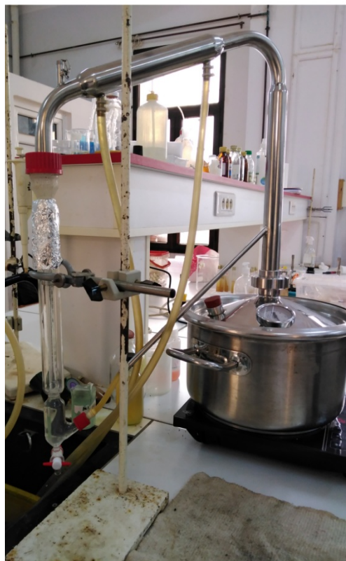
Figure n° 19. Dispositif d'extraction des huiles essentielles par entrainement à la vapeur d'eau.
