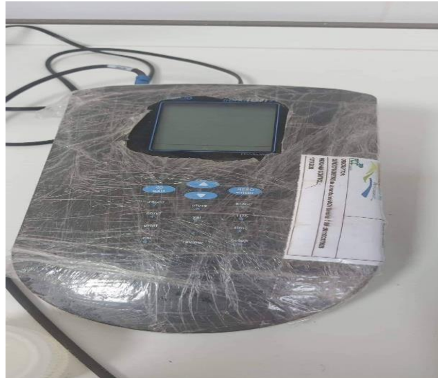
Figure 9: Photo prise sur le conductimètre ( laboratoire de dessalement sonachter)
