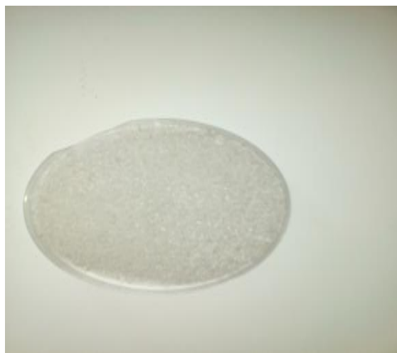
Figure III.30 : Aspect du chitosane après désacétylation. NaOH à 50%.
