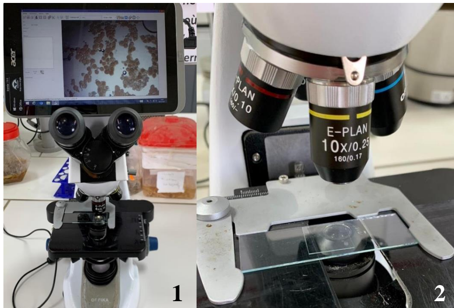
Figure II. 2. Détermination du diamètre ovocytaire grâce au Microscope optique Optika à caméra intégré.
