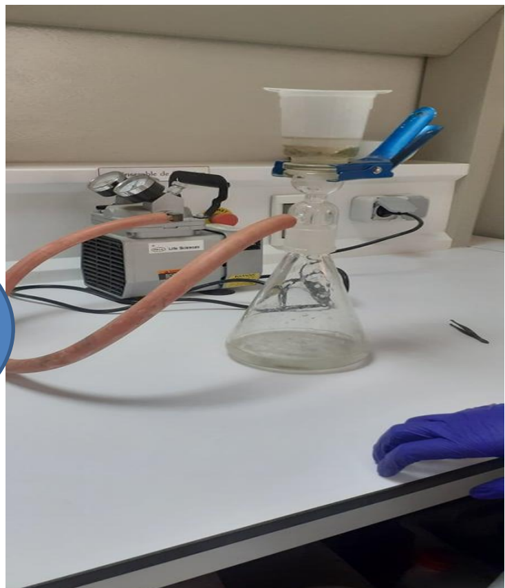
Figure 18 : Ensemble de filtration avec pompe sou vide (Benhalima&Elahouel 2022).
