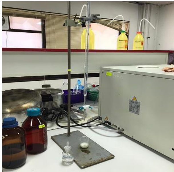
Figure 17. L'opération du titrage de l'acidité dornic
