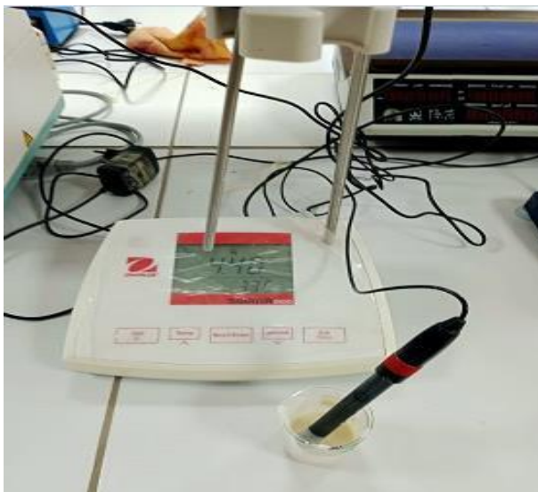
Figure 16. Mesure du PH par un PH mètre
