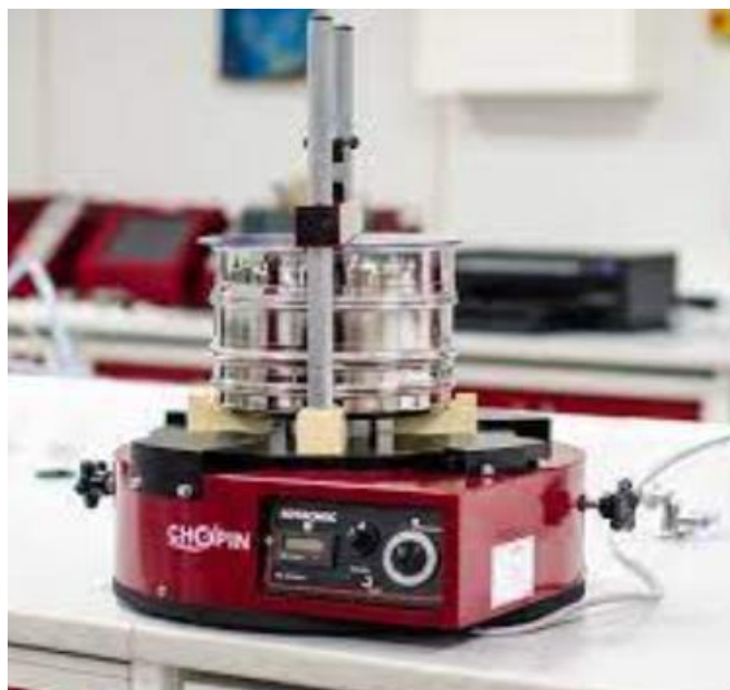
Figure 14. Équipement du Rotachock de Chopin Technologie
