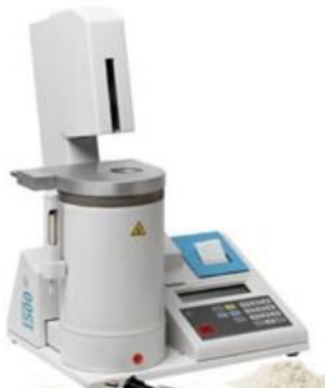
Figure 15. Équipement de Falling Number
