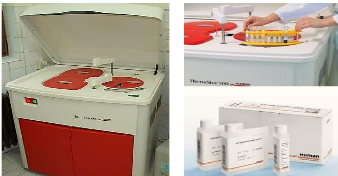
Figure 9. Analyseur «HumaStar 600 » avec ses réactifs (Société humaine de biochimie et de diagnostic mbH).
