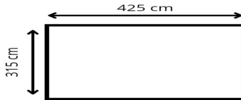
Figure 7.2 : Dimensions du panneau de la dalle le plus sollicité
