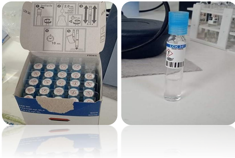
Figure 18 : image montre les étapes de travail pour la mesure de nitrite. Figure 19: tube de la solution LCK 341 (NO 2 -N)
