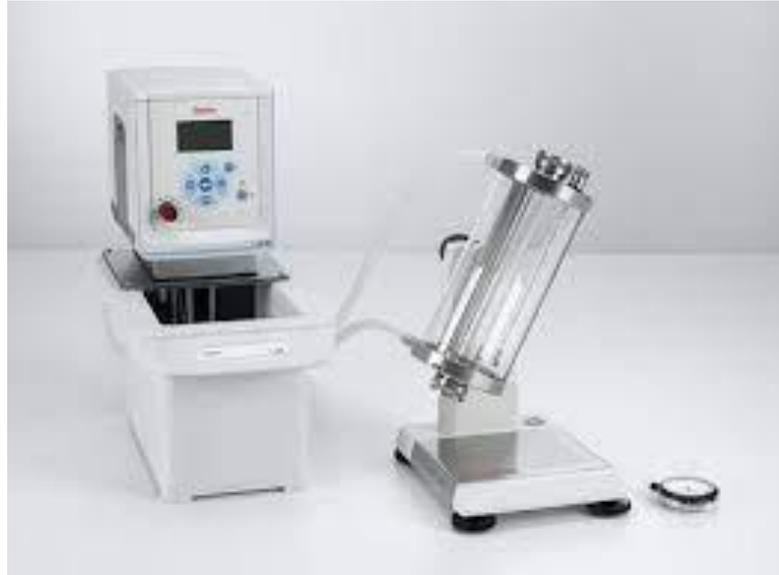
**Photo du viscosimètre à bille**
