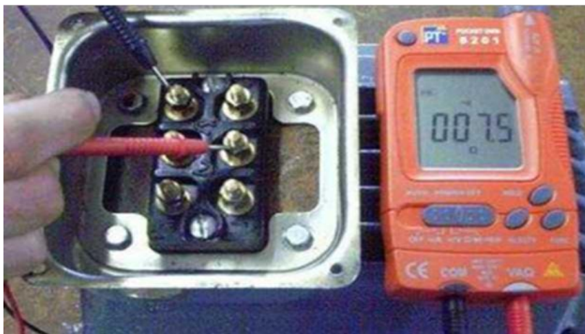
Figure (IV.7) : Vérification des bobines
