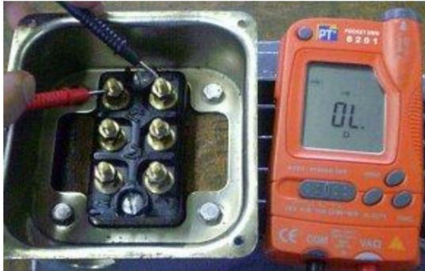
Figure (IV.6) : L'isolement entre les 3 enroulements
