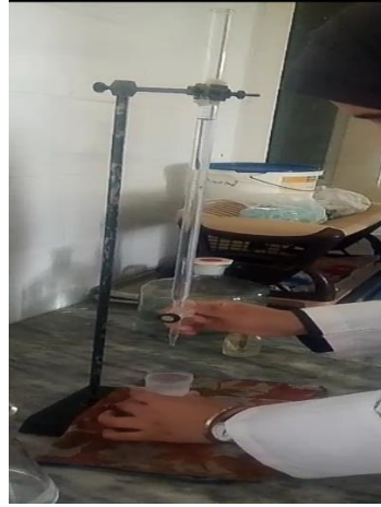
Figure 17 : Mesure d'acidité titrable en °D.
