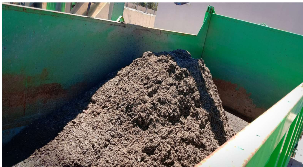
Figure II.3 : Image des macros déchets du dégrillage fin
