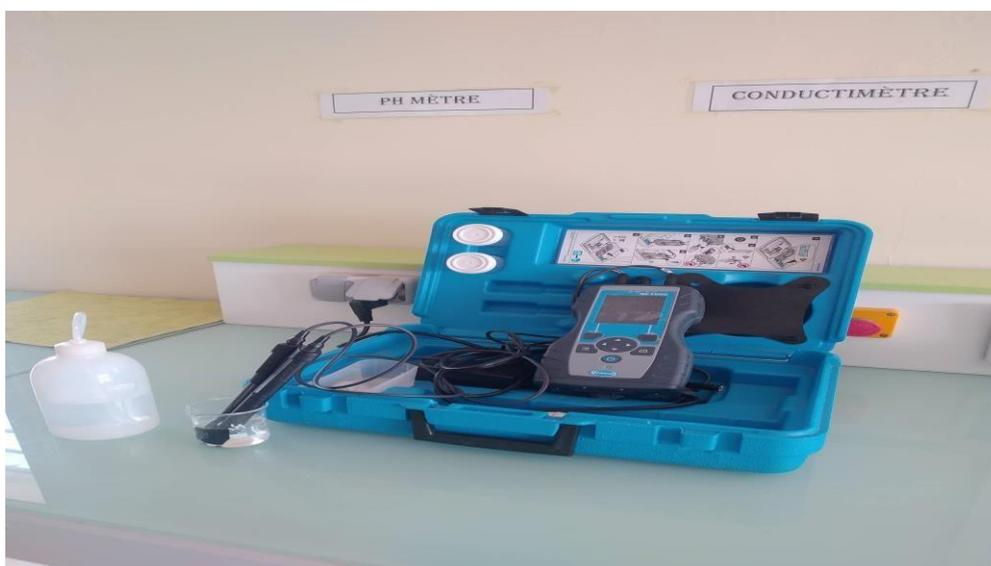
Ph-mètre et conductimètre (source : hind2022).
