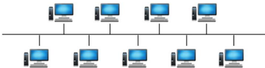
Figure III-2 : Réseau en topologie « Bus »
