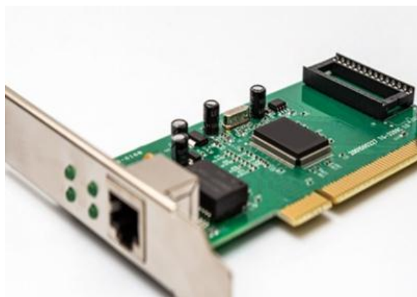
Figure I-11: Carte de réseau d'un PC de bureau
