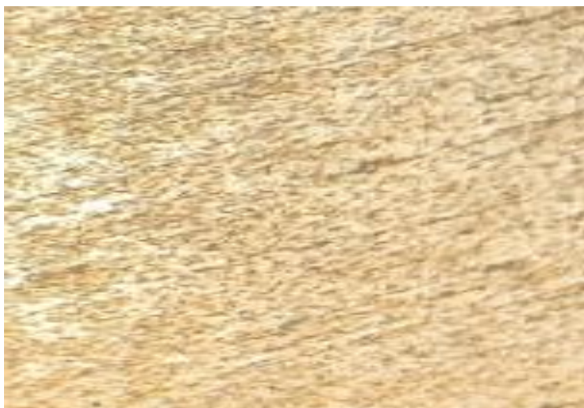
Figure III.2 : Micrographie optique de l'acier 41Cr4 à l'état trempé (grossissement X400)
