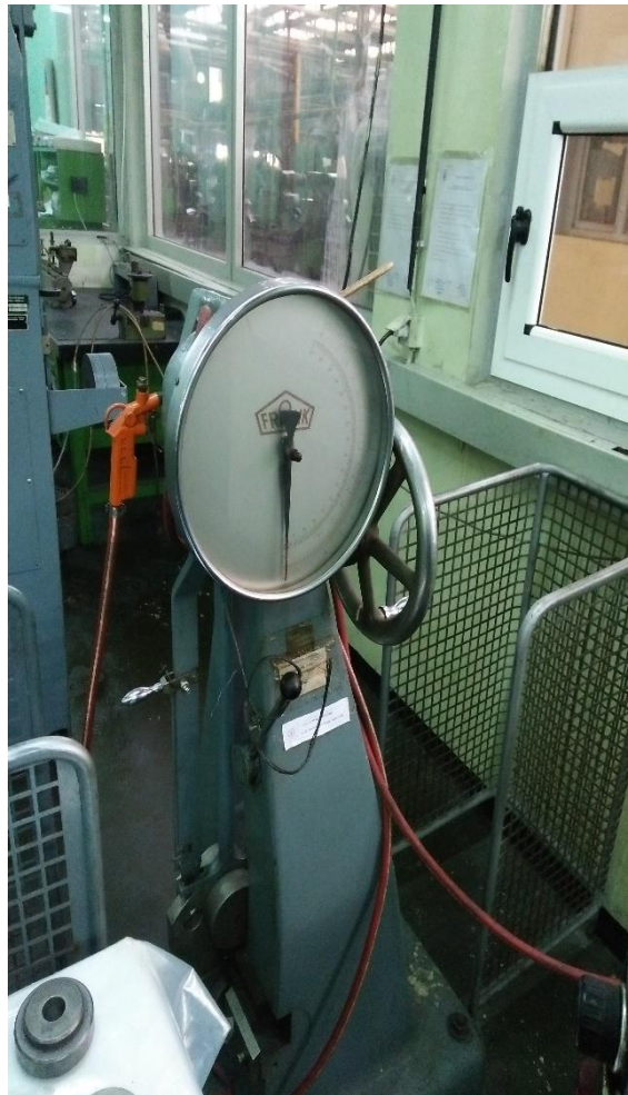
Figure II.19 : Machine de résilience marque « KARL FRANK GMBH »
