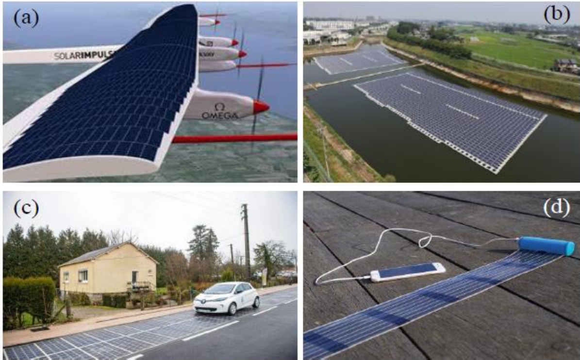
Figure 1.22 : Exemples d'applications de cellules photovoltaïques : (a) Avion 100% solaire du projet Solar Impulse, qui a fait un tour du monde en 2016 [20]. (b) Panneaux solaires flottants au Japon [21]. (c) Tronçon routier de 1 km recouvert de panneaux photovoltaïques en Normandie (France) [22]. (d) Batterie solaire pour smartphone, utilisant des cellules solaires organiques imprimées [23].
